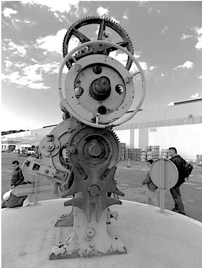
À l'entrée de la tuilerie ultramoderne, un vestige de l'industrie passée : une presse mécanique à vapeur.
