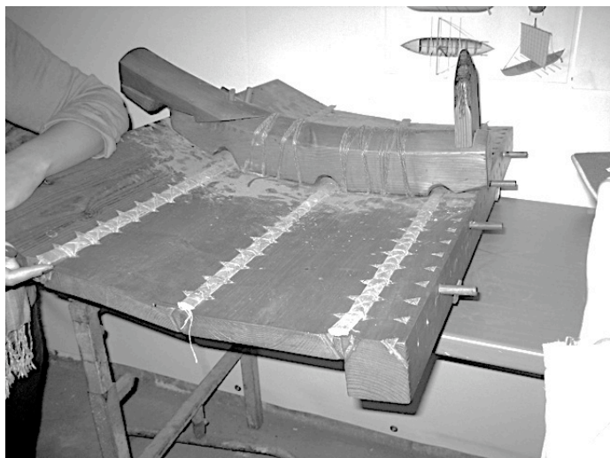
Technique de construction des bateaux « cousus » au VI ème avant J-C.
